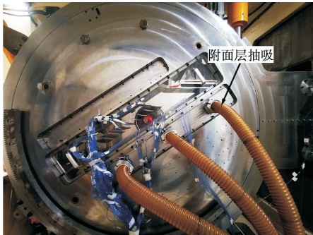
(b) 试验舱试验件安装图
